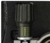
**La escala graduada de la perilla reguladora de presión del alambre** proporciona un ajuste fácil y una presión uniforme en los rodillos de accionamiento y el alambre.
