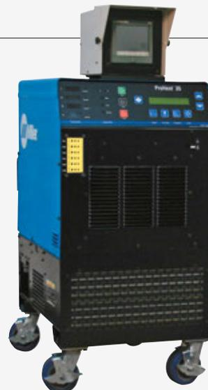
Se muestra la fuente de alimentación ProHeat 35 con enfriador de trabajo pesado para calentadores por inducción, el tren rodante y el registrador digital.
