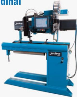
Las soldadoras de costura longitudinal Jetline ofrecen velocidad y precisión. Las características incluyen la soldadura lineal, la producción de cilindros de alto volumen, la unión de láminas de espesor delgado o bobinadas y más.
