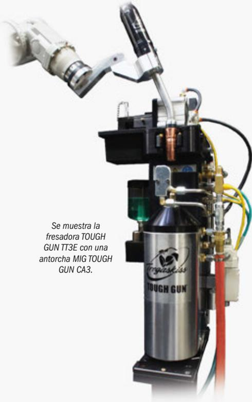
Se muestra la fresadora TOUGH GUN TT3E con una antorcha MIG TOUGH GUN CA3.
