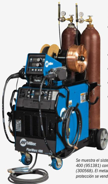
Se muestra el sistema de soldadura PipeWorx 400 (951381) con el kit de accesorios (300568). El metal de relleno y el gas de protección se venden por separado.
