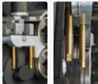
**Los pasadores de la guía de entrada de fricción ultrabaja** facilitan la carga del alambre sin deformarlo en el camino hacia los rodillos de alimentación, lo cual mejora el rendimiento de la alimentación.
